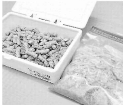
乾燥・破砕した使用済み紙おむつに木くずを混ぜたもの(右)と完成した固形燃料
