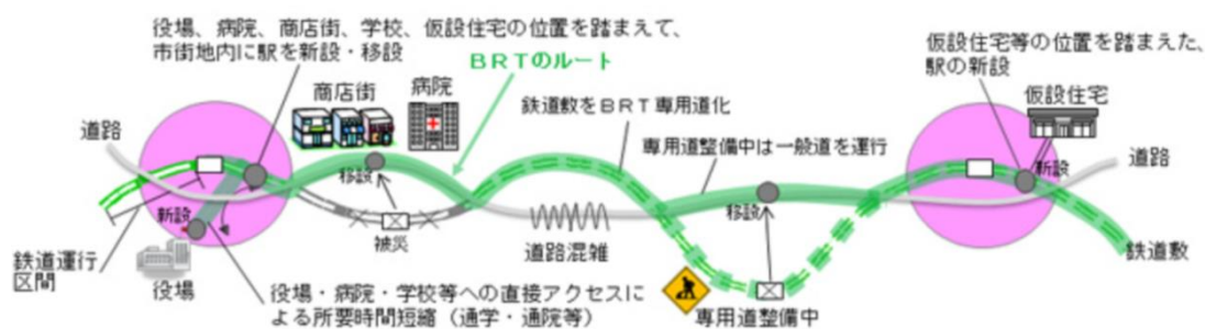
図 4-1① BRT による復旧のイメージ
