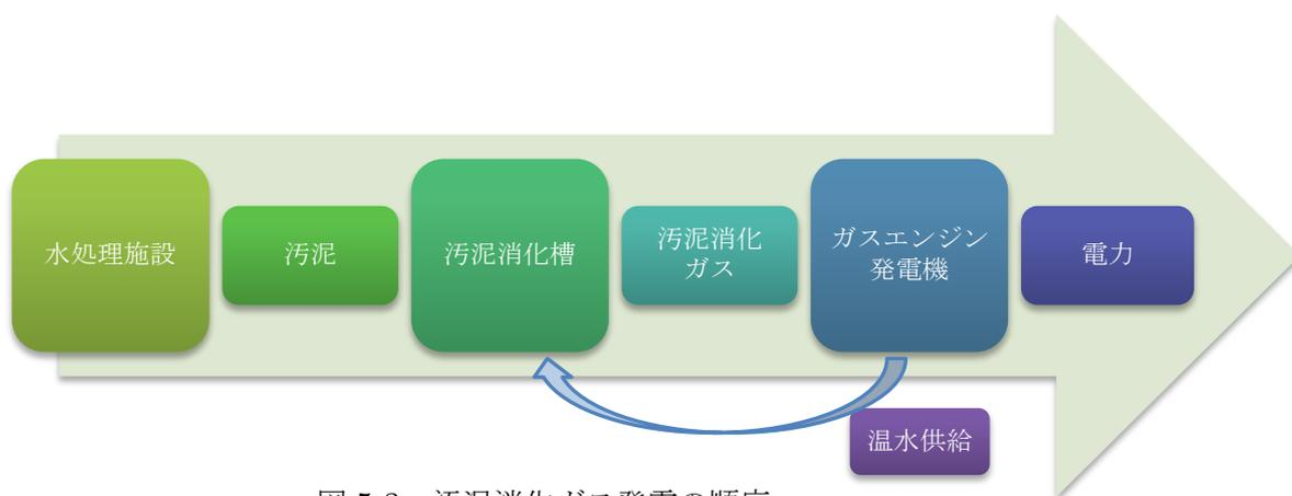
図 5-3 汚泥消化ガス発電の順序
