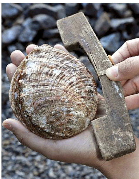
図 4 アワビの大きさが 10.6cm 未満でないか測る道具「スンボウ」
