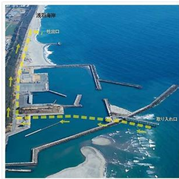
図 8 ジェットポンプ式サンドバイパス工法を俯瞰
